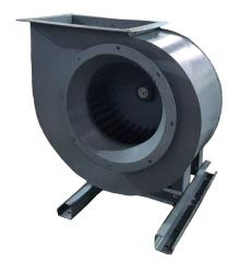
Вентиляторы общего назначения из углеродистой стали ВР 300-45 предназначены для перемещения воздуха и других газовых смесей, агрессивность которых, по отношению к углеродистым сталям обыкновенного качества не выше агрессивности воздуха с температурой до  $+80^{\circ}$ С. Исполнение ОП 1 - детали вентилятора изготавливаются из углеродистой оцинкованной стали.
