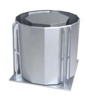
Вентиляторы общего назначения из углеродистой стали ВКР предназначены для перемещения воздуха и других газовых смесей, агрессивность которых по отношению к углеродистым сталям обыкновенного качества не выше агрессивности воздуха с температурой до  $+50^{\circ}$ C, не вызывающих ускоренной коррозии алюминиевых сплавов (скорость коррозии не выше 0,1 мм в год), с содержание пыли и других твёрдых примесей не более 100 мг/м³, не содержащих липких веществ и волокнистых материалов.
