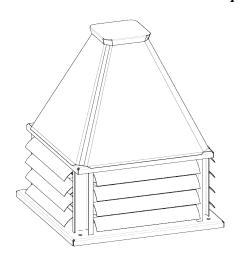
Вентиляторы общего назначения из углеродистой стали ВКР предназначены для перемещения воздуха и других газовых смесей, агрессивность которых по отношению к углеродистым сталям обыкновенного качества не выше агрессивности воздуха с температурой до +50°C, не вызывающих ускоренной коррозии алюминиевых сплавов (скорость коррозии не выше 0,1 мм в год), с содержание пыли и других твёрдых примесей не более 100 мг/м³, не содержащих липких веществ и волокнистых материалов.
