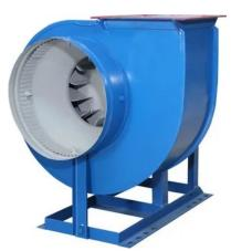
Вентиляторы общего назначения из углеродистой стали ВР 86-77, ВР 80-70 предназначены для перемещения воздуха и других газовых смесей, агрессивность которых, по отношению к углеродистым сталям обыкновенного качества не выше агрессивности воздуха с температурой до +80°C. Исполнение ОП 1 - детали вентилятора изготавливаются из углеродистой оцинкованной стали.
